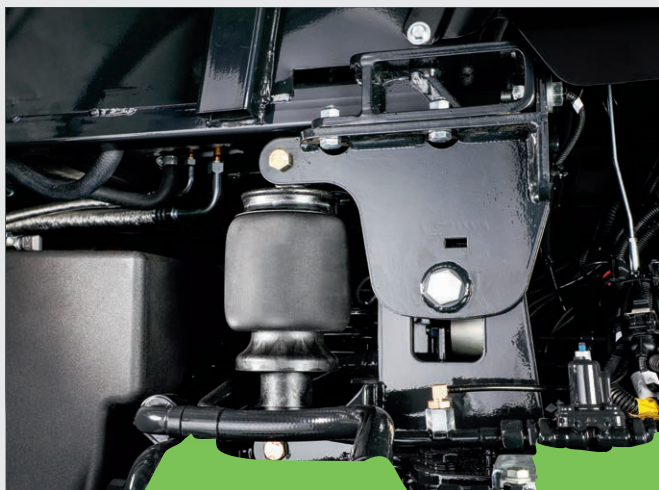
↑ Πνευματική ανάρτηση καμπίνας για πιο ομαλή οδήγηση.
