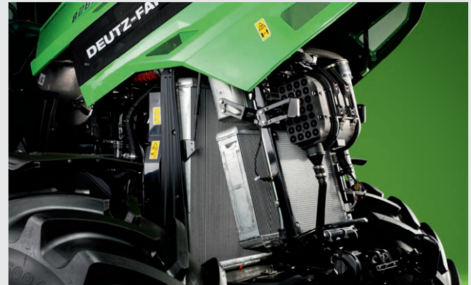
↑ Εύκολη πρόσβαση στο ψυγείο και στο φίλτρο αέρα.
