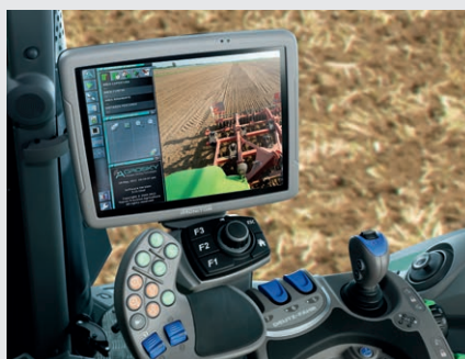
↑ Ενσωματωμένη κάμερα με αυτόματη λειτουργία πλήρους οθόνης (π.χ. όπισθεν) για σαφή επισκόπηση και ασφάλεια.
