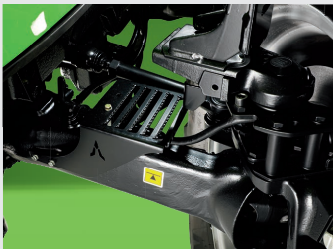
↑ Σκαλοπάτια συντήρησης πάνω από τον μπροστινό άξονα για άνετο καθαρίσμα.
