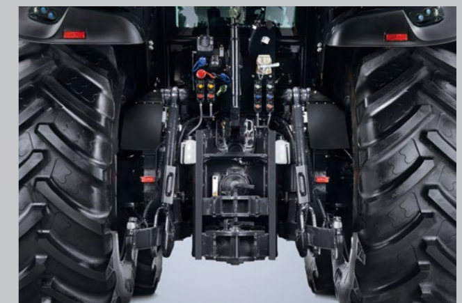
Έξοδος υδραυλικού συστήματος έως 160 l/min, ικανότητα ανύψωσης 10.000 kg και τέσσερις ταχύτητες PTO. Όλα είναι πιθανά.
