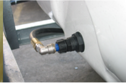
Ανάδευση με πίδακα για την ανάμειξη της χημικής ουσίας και τη διατήρηση των συγκεντρώσεων του μείγματος κατά τις φάσεις του ψεκασμού
