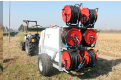
Σταθμοί ψεκασμού κατάλληλοι για 6 χρήστες και έναν οδηγό για να ψεκάσουν ανεξάρτητα το μείγμα έως και 100 μέτρα από τον ψεκαστήρα
