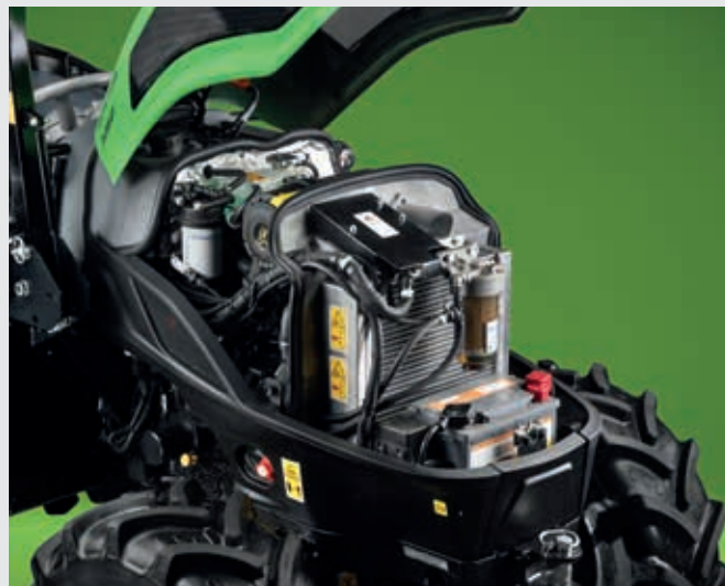
↑ Κινητήρες συμβατοί με τους κανονισμούς Stage V με έγχυση Common Rail και μέγιστη ισχύ 59 HP.
