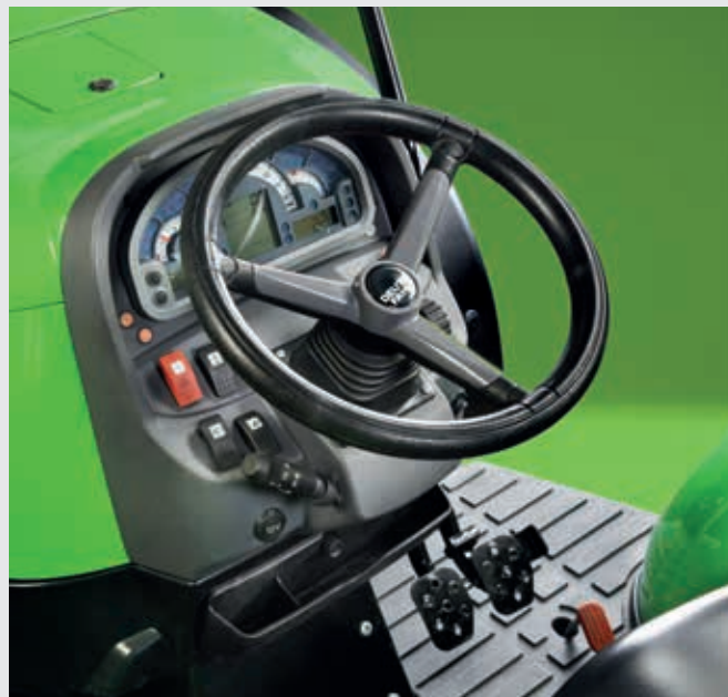
↕ Ρυθμιζόμενη κολόνα τιμονιού και ψηφιακός πίνακας οργάνων.
