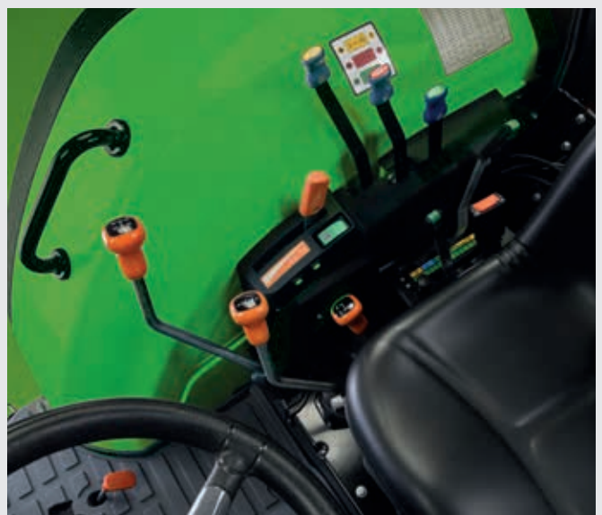
🟢 Νέα διάταξη χειριστηρίων διανομέα και σύστημα EasyLift.
