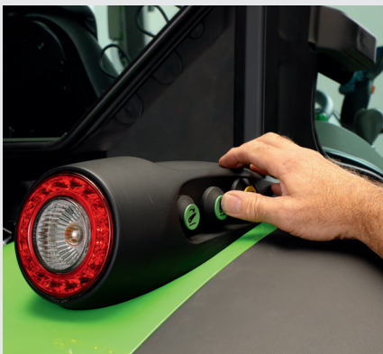
↑ Το πίσω ανυψωτικό και το PTO διαθέτουν εξωτερικά χειριστήρια στους πίσω λασπωτήρες.
