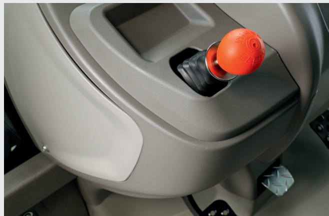
↑ Ασφαλές παρκάρισμα ακόμα και σε λοφώδεις συνθήκες χάρη στο ισχυρό χειρόφρενο HPB.
