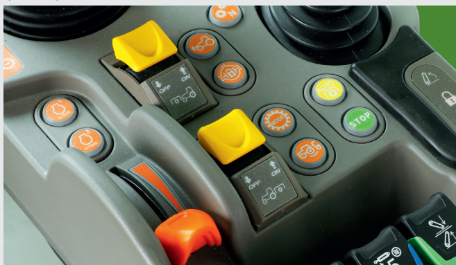
↑ Εύκολη εμπλοκή του μπροστινού και του πίσω PTO μέσω κουμπιών στο υποβραχιόνιο MaxCom.
