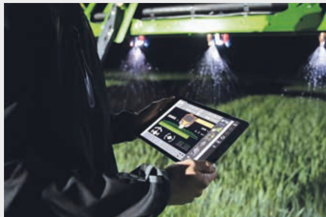
↑ Λειτουργία XTEND, έλεγχος εργαλείων με ISOBUS UT μέσω tablet ενώ βρίσκεστε εκτός καμπίνας.
