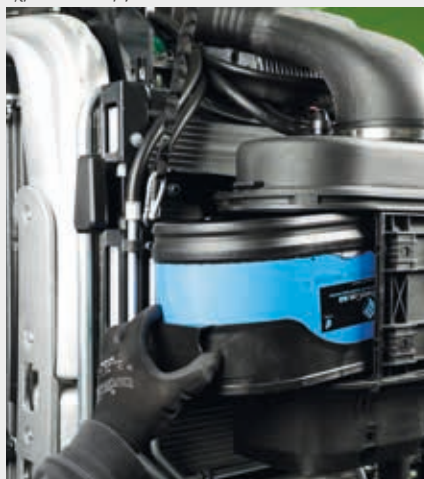
↑ Φίλτρο αέρα με μονάδα προκαθαρισμού.
