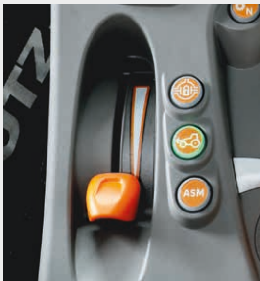
↑ Ανεξάρτητο γκάτζι χειρός και ηλεκτροϋδραυλική ενεργοποίηση κλειδώματος διαφορικού, τετρακίνηση και λειτουργία ASM.
