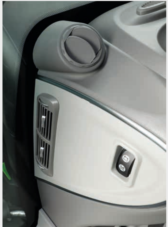
📌 Νέες ρυθμιζόμενες εξόδους αέρα και ο διακόπτης μπαταρίας τοποθετημένος βολικά στην αριστερή κολόνα του τιμονιού.
