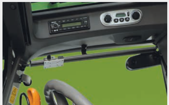
📌 Διεπαφές ελέγχου ραδιοφώνου, εναλλασσόμενου ρεύματος και φώτων καθώς και συρόμενη βάση οθόνης.
