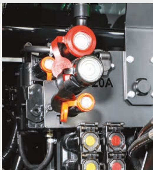
⬆ Power Beyond με ζεύκτες επίπεδης όψης για καθαρή σύνδεση.
