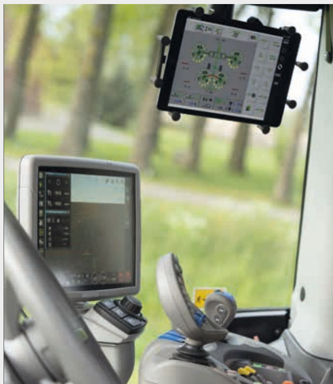
↑ Η λειτουργία XTEND επιτρέπει την εμφάνιση της Καθοδήγησης SDF ή σας επιτρέπει να ελέγχετε ένα εργαλείο ISOBUS σε μια εξωτερική συσκευή, π.χ. ένα tablet.
