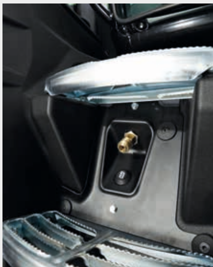
↑ Θύρα τροφοδοσίας ir και διακόπτης φωτών εισόδου προστατευμένα κάτω από τα σκαλοπάτια.
