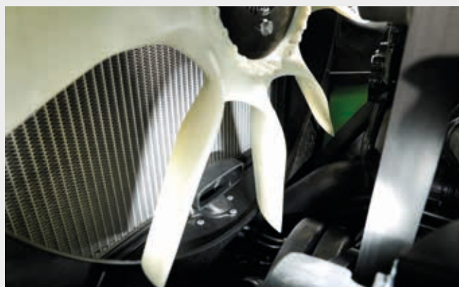
↑ Ηλεκτρονικός ιξωδοστατικός ανεμιστήρας (eVisco) με σωλήνα αναρρόφησης για το σύστημα προκαθαρισμού του φίλτρου αέρα (αφαιρεί το 95% των χονδροειδών σωματιδίων προτού φτάσουν στα φίλτρα).
