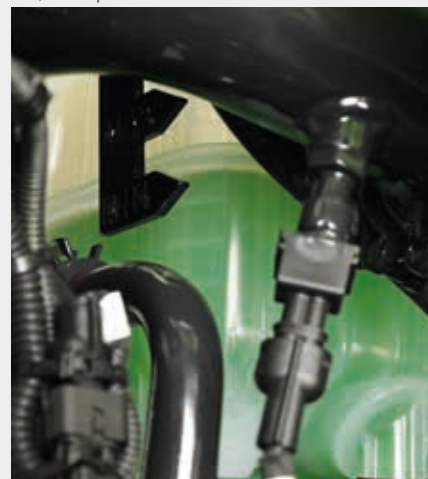
↑ Δεξαμενή νερού με δείκτη στάθμης χάλυβα.
