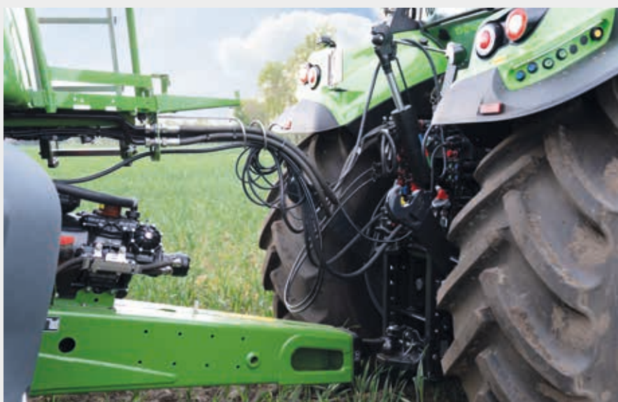
⬆ Πίσω σύνδεσμος στη θέση μεταφοράς για μη παρεμβολή με τις ράβδους έλξης κατά τις στροφές.
