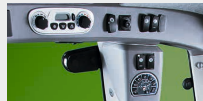
☒ Φώτα οδήγησης, φώτα εργασίας και φώτα καμπίνας όλα σε έναν πίνακα ελέγχου. Επιλέξτε το κλίμα εργασίας και η αυτόματη λειτουργία ελέγχου της ροής του αέρα.
