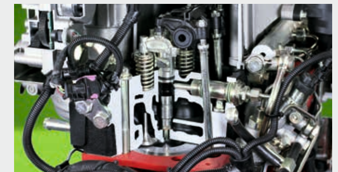
↑ Τεχνολογία CR: Η πίεση ψεκασμού 2.000 bar εξασφαλίζει μέγιστη απόδοση κινητήρα.
