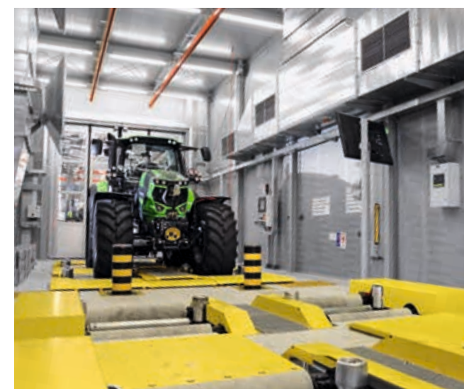
Μοναδικό στην κατασκευή τρακτέρ: δυναμόμετρο πλαισίου και δοκιμαστική κλίνη ανάρτησης άξονα.
