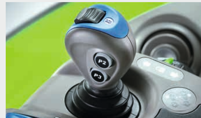
Ο μοχλός εγκάρσιου ελέγχου με διακόπτη στρόφρα ελέγχει τρεις υδραυλικές βαλβίδες ελέγχου.
