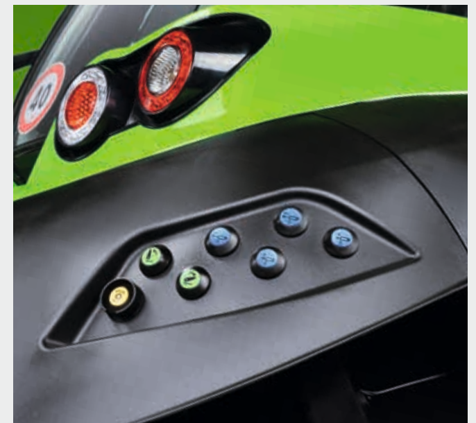
➤ Ο εξωτερικός έλεγχος των υδραυλικών και των λειτουργιών PTO λειτουργεί και από τις δύο πλευρές.
