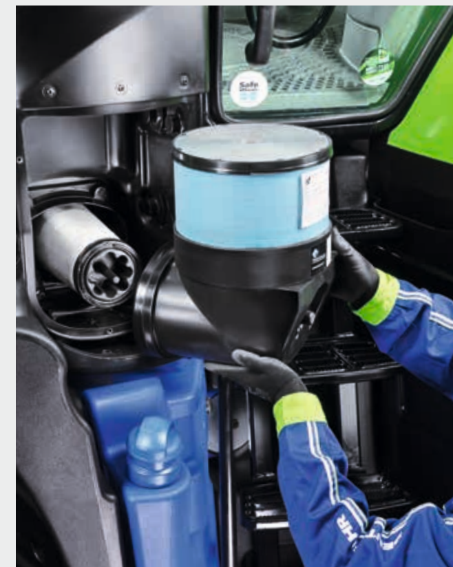
↑ Το φίλτρο αέρα κινητήρα τοποθετείται και αφαιρείται εύκολα.
