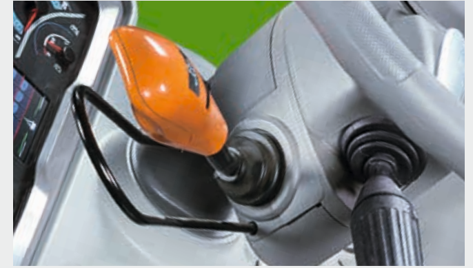
▶ Στάνταρ: Σύστημα Powershuttle. Η ευαισθησία (σκληρό - μεσαίο - μαλακό) μπορεί εύκολα να ρυθμιστεί με χειριστήριο αντίχειρα.
