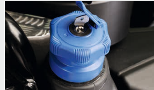
↑ Καλύμματα δεξαμενής καυσίμου και δεξαμενές AdBlue που μπορούν να κλειδωθούν.
