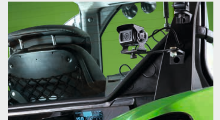
↑ Ενσωματωμένη κάμερα με αυτόματη λειτουργία πλήρους οθόνης (π.χ. όπισθεν) για επισκόπηση και ασφάλεια.
