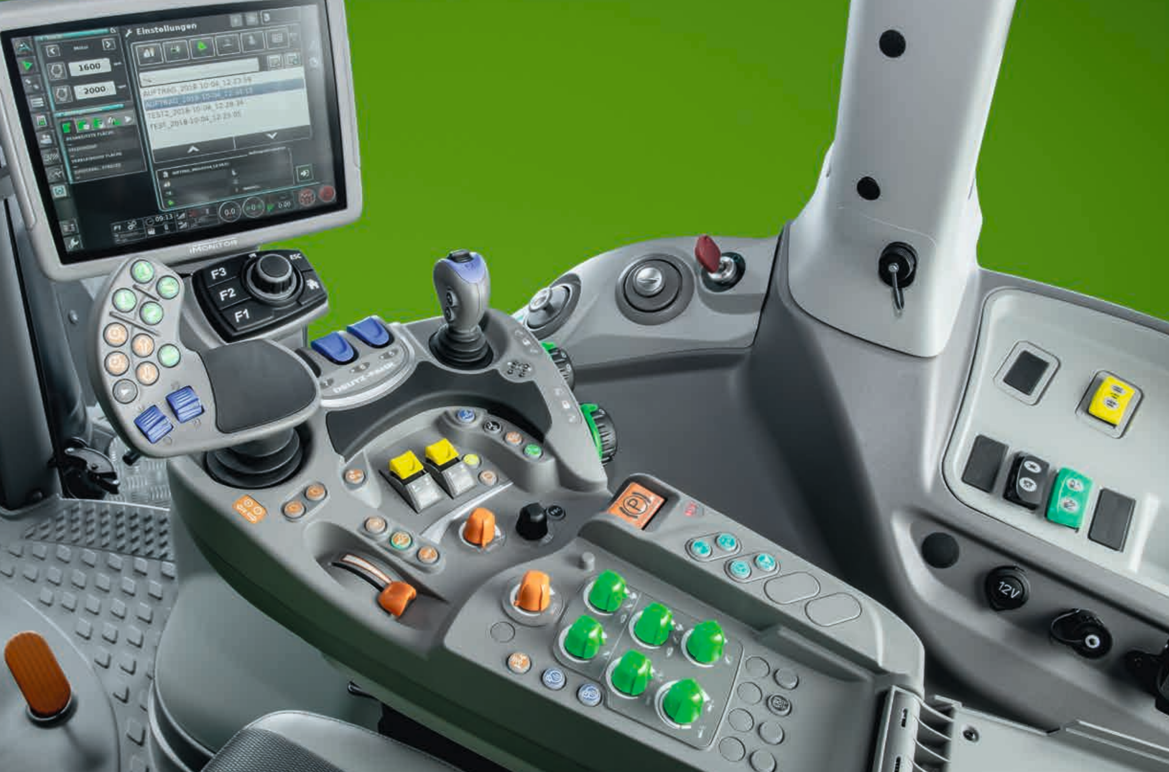
Ο μοχλός εγκάρσιου ελέγχου με διακόπτη στρόφρα ελέγχει τρεις υδραυλικές βαλβίδες ελέγχου.
