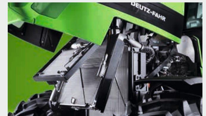
↑ Το ψυγείο του κινητήρα μπορεί να ανοίξει και να καθαριστεί εύκολα.
