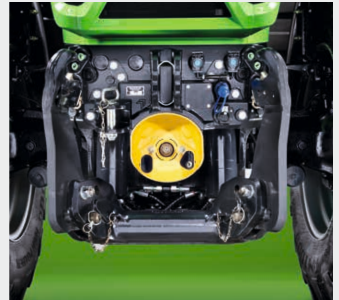
➤ Ενσωματωμένη μπροστινή σύνδεση με μοναδικά μικρή απόσταση από τον μπροστινό άξονα. Χαμηλή προεξοχή. Καλύτερη ισορροπία τρακτέρ.
